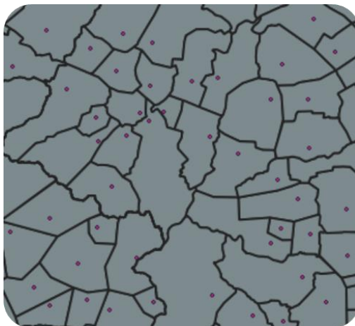
Slika 21 - Primjer MDF-ova i njihovih područja pokrivanja (izvor: Axon na osnovu podataka HT-a)
